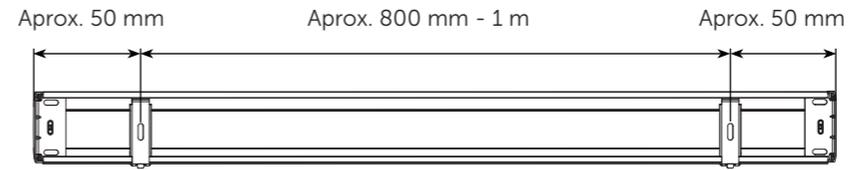
Centra el mecanismo del estor (A) a la ventana, coloca los soportes (B) y marca con un lápiz los puntos a taladrar.
