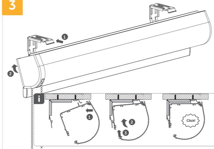
Engancha el mecanismo del estor (A) a los soportes (B).
