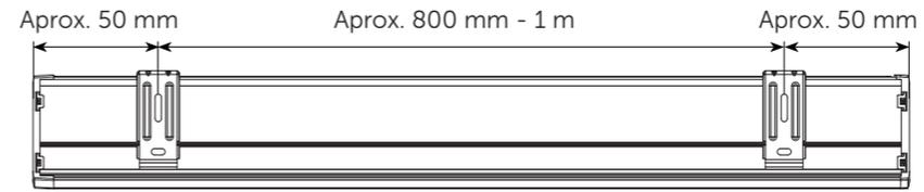
Centra el mecanismo del estor (A) a la ventana, coloca los soportes (B) y marca con un lápiz los puntos a taladrar.
